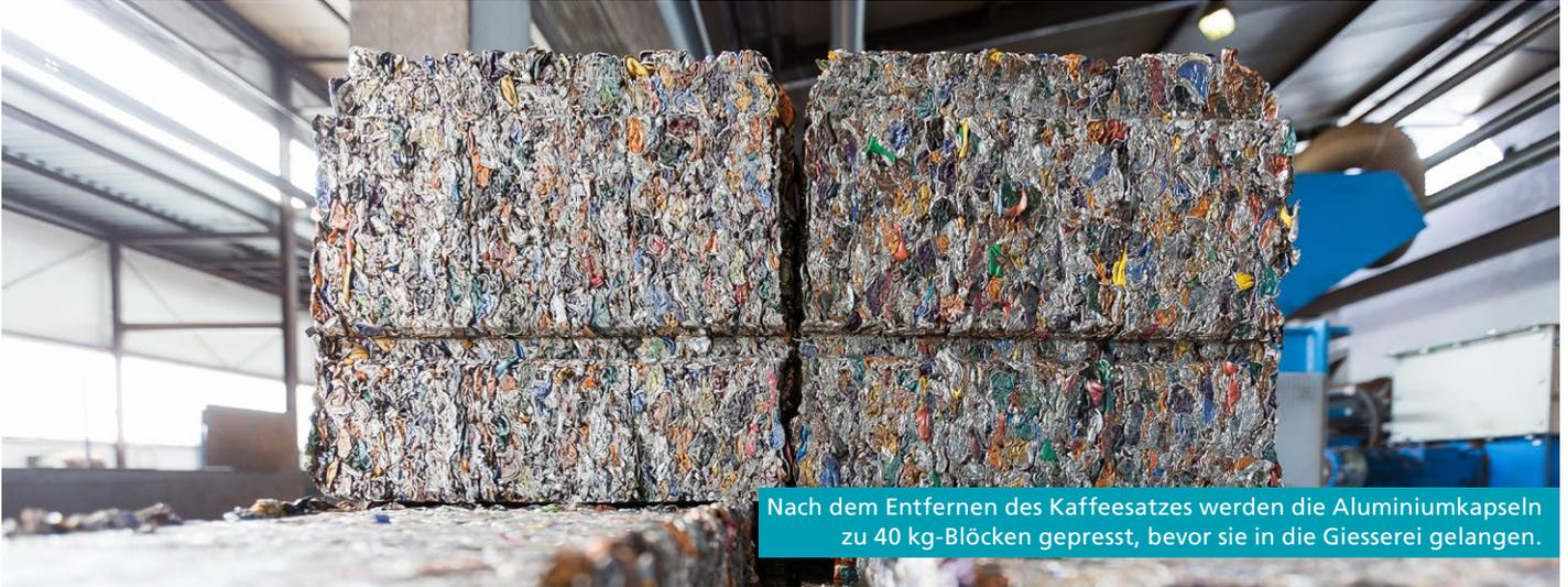
Nach dem Entfernen des Kaffeesatzes werden die Aluminiumkapseln zu 40 kg-Blöcken gepresst, bevor sie in die Giesserei gelangen.
